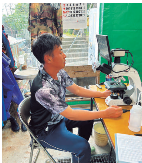
モニター付き顕微鏡。モニターを設置することで、ほかの生産者と共有しながら検鏡ができる。
