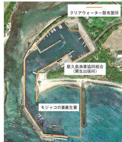
栗生におけるクリアウォーターの散布箇所。約3万3,700m 2 の湾に1.8t(90袋)を船上から散布する。栗生以外にも、志戸子と上屋久のモジャコ基地に導入されている。
