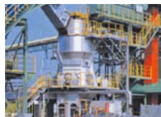
粉碎設備 (粉碎設備) 石灰石を粉碎し炭酸カルシウムを生産する設備
