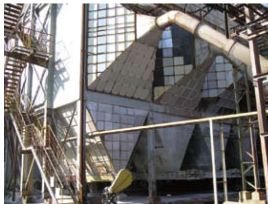
キルン排ガスの電気集塵機（9基）
